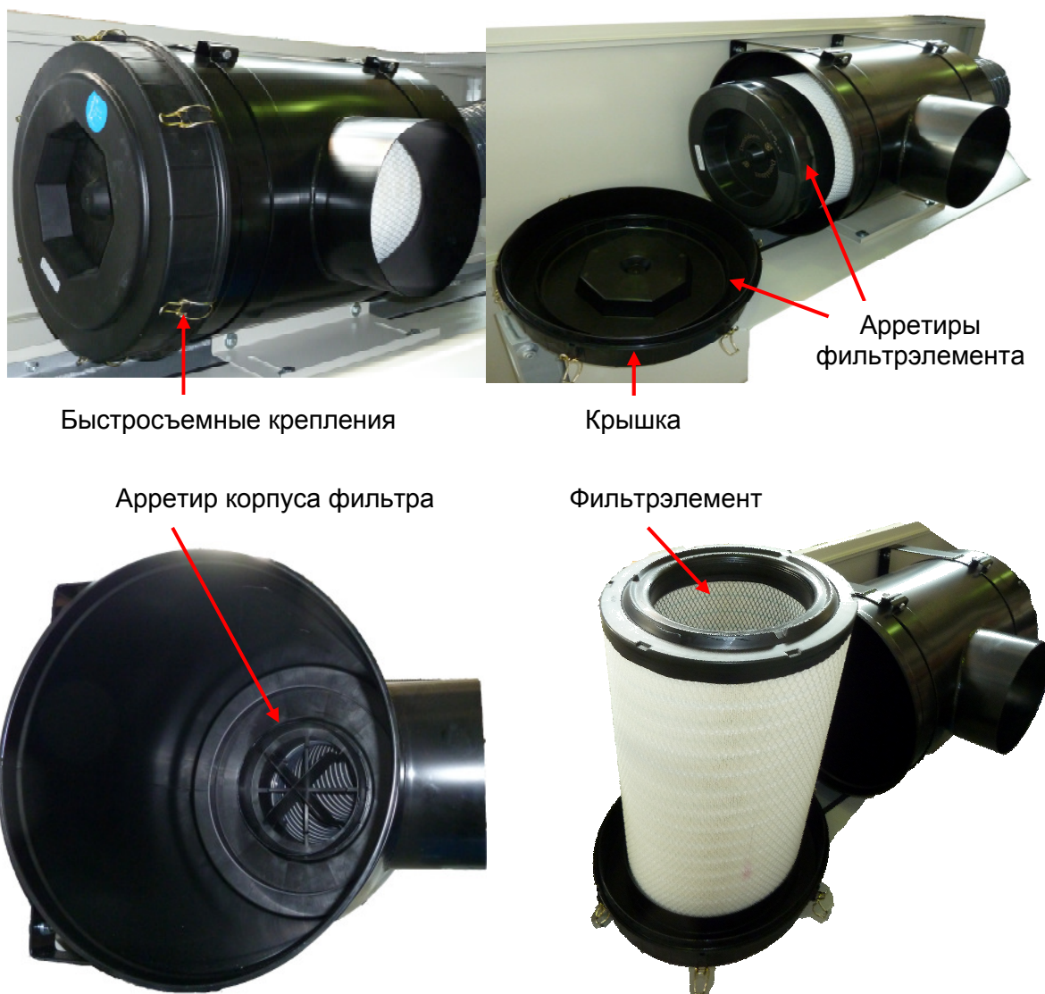
Рис. Замена патрона воздушного фильтра.
